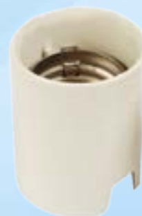
01.05.30 - 00.75.30 Receptáculo casquilho em latão niquelado Jagged socket receptacle in nickel plated brass 16 A - 500 V - Rosca E-40
